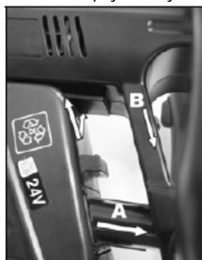
Zasuňte akumulátor do k tomuto účelu určeného uchycení, a to tak hluboko, až zacvakne (A). Pošoupněte blokování (B) ve směru šipky.
