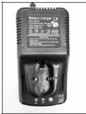
Collegare il caricabatteria con la presa (la spia OFF si accende). Premere il tasto SET (ora la spia ON è accesa). La spia ON si spegne dopo ca. 1-1,5 ore e la spia OFF si accende- il pacco accumulatore è caricato.
